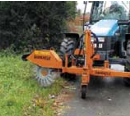
Foto 17. Borstelen met verticale borstels.
